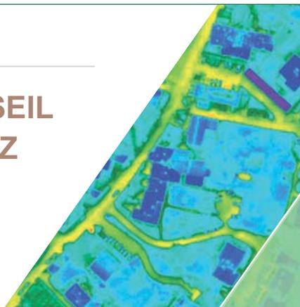
L'Association des communes genevoises (ACG), avec le soutien de l'Etat de Genève, a réalisé en 2011 une thermographie aérienne de l'ensemble du canton. Cette opération permet de visualiser le rayonnement thermique des toitures. Ces résultats sont disponibles sur le guichet cartographique du Système d'Information du Territoire Genevois SITG ([www.ge.ch/sitg](http://www.ge.ch/sitg)).
